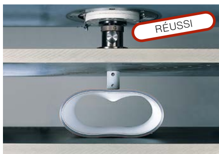
Essai de perforation avec poinçon
