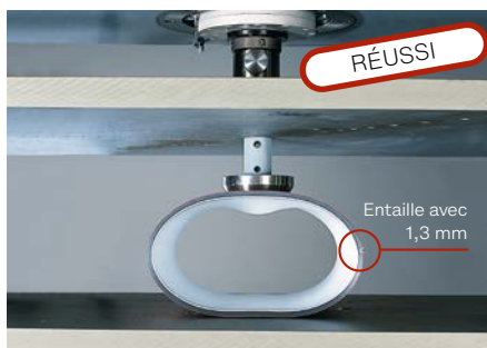
Essai de charge ponctuelle avec entaille latérale
